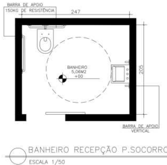
Figura 21: Projeto do banheiro Recepção Pronto Socorro - HABF
