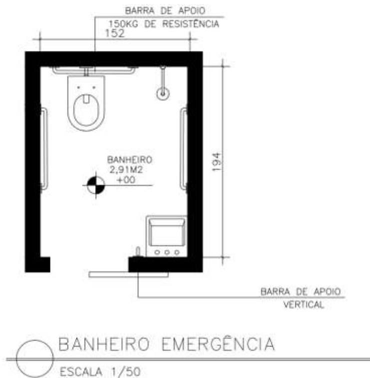
Figura 23: Projeto banheiro da emergência - HABF
