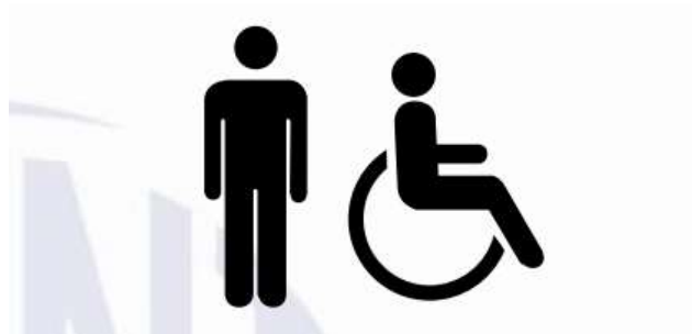
Figura 2: Sinalização de sanitário masculino acessível. Norma ABNT 9050.
