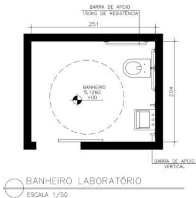
Figura 30: Projeto banheiro do Laboratório - HABF
