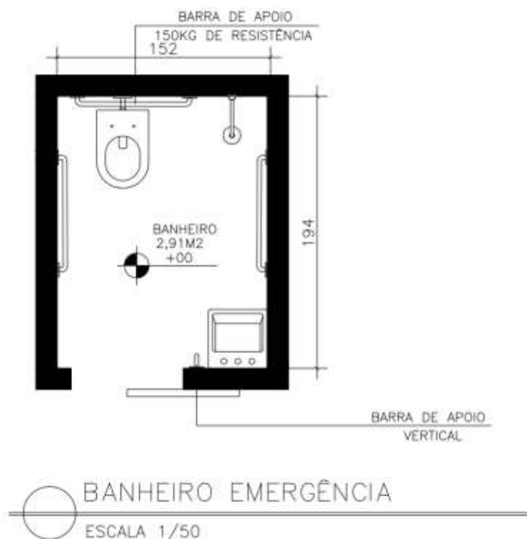
Figura 23: Projeto banheiro da emergência - HABF
